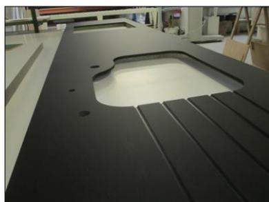
Fabrication Leroux-Formes & Plans- Plan de travail en Compact Fenix Noir profond, doublé sur agglé CTBH et plaqué chant ABS. Usinages sur mesure
